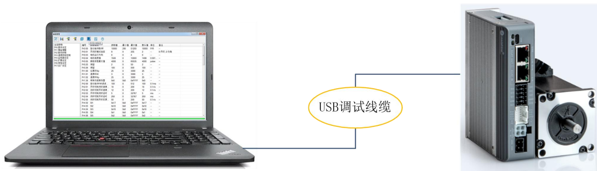
图 4-2 驱动器与 PC 的连接示意图
